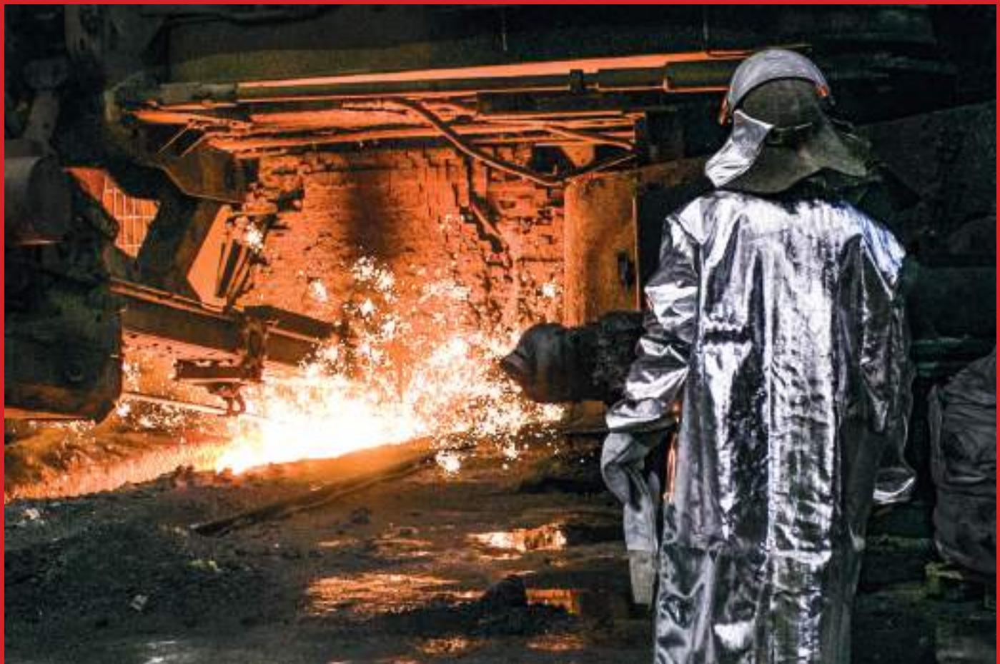
Но это еще не все: сталеплавильное производство выдает слябы — слитки металла толщиной до 350 миллиметров, длиной до 12 метров и весом до 30 тонн. На прокатном производстве их сначала нагревают до красного каления, а потом, словно податливое тесто, превращают в лист нужной толщины. Кроме цехов горячей прокатки на ММК работают и цеха холодной прокатки металла, где создается стальной лист более точных размеров с высоким качеством поверхности.
