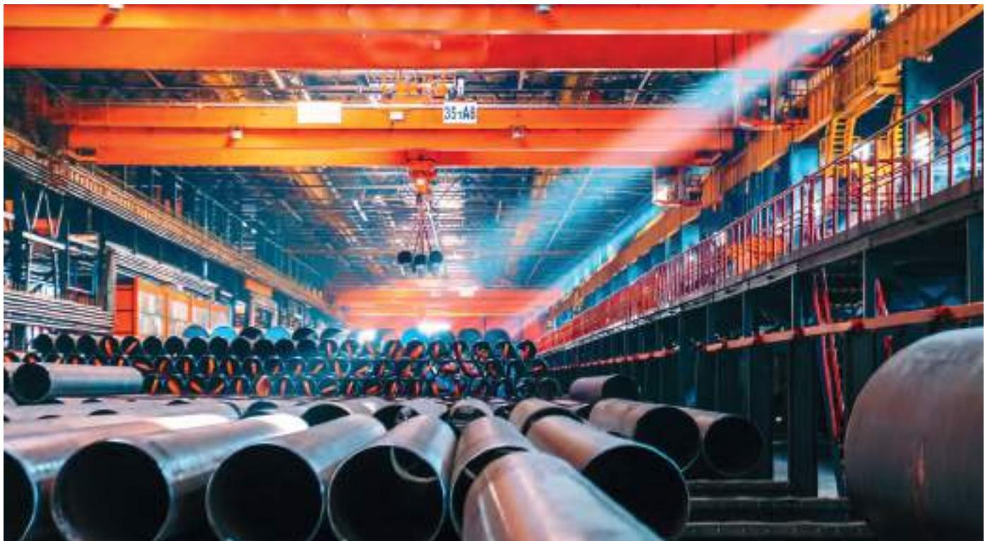
**ЦЕХ ВЫПУСКАЕТ ТРУБЫ** диаметром от 508 до 1422 миллиметров с внутренним и внешним антакоррозионным покрытием, а в кооперации с еще одним трубоэлектросварочным цехом производит трубы диаметром 2500 миллиметров. Продукцию цеха используют в условиях вечной мерзлоты, в сейсмоопасных зонах и на дне морей.
