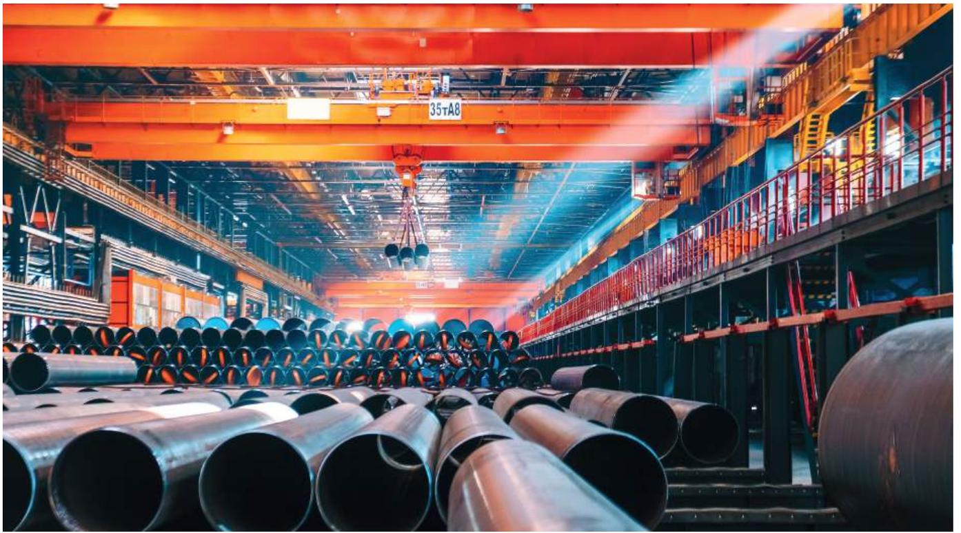
该车间生产直径508至1422毫米、带有内外防腐涂层的管材，并与另一家焊管车间合作生产直径达2500毫米的特大型管道。其产品适用于永久冻土带、地震活跃区和海底环境。参观这座工业生产基地的体验堪比迪士尼乐园——《239高地》车间以其明亮宽敞的空间、现代化设备和极致安全性，完美诠释了什么是创新工厂的典范：洁净、美观且充满设计感。
