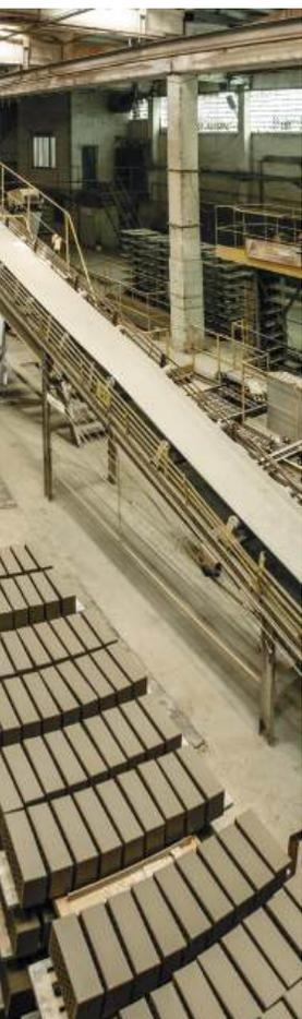
现代陶瓷砖的制造过程包括黏土与砂石及添加剂混合后，经过干燥、压制成型、施釉和窑烧等工序，但这仅是工艺流程的简版说明，实际细节远比想象的精妙复杂。若想获取第一手生产技术，推荐探访联盟国家陶瓷行业的领军企业，例如俄罗斯奥廖尔州的KERAMA MARAZZI工厂
